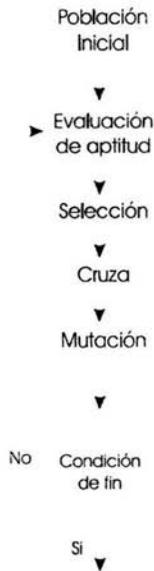
Figura 2.1: Diagrama de flujo de un AG
