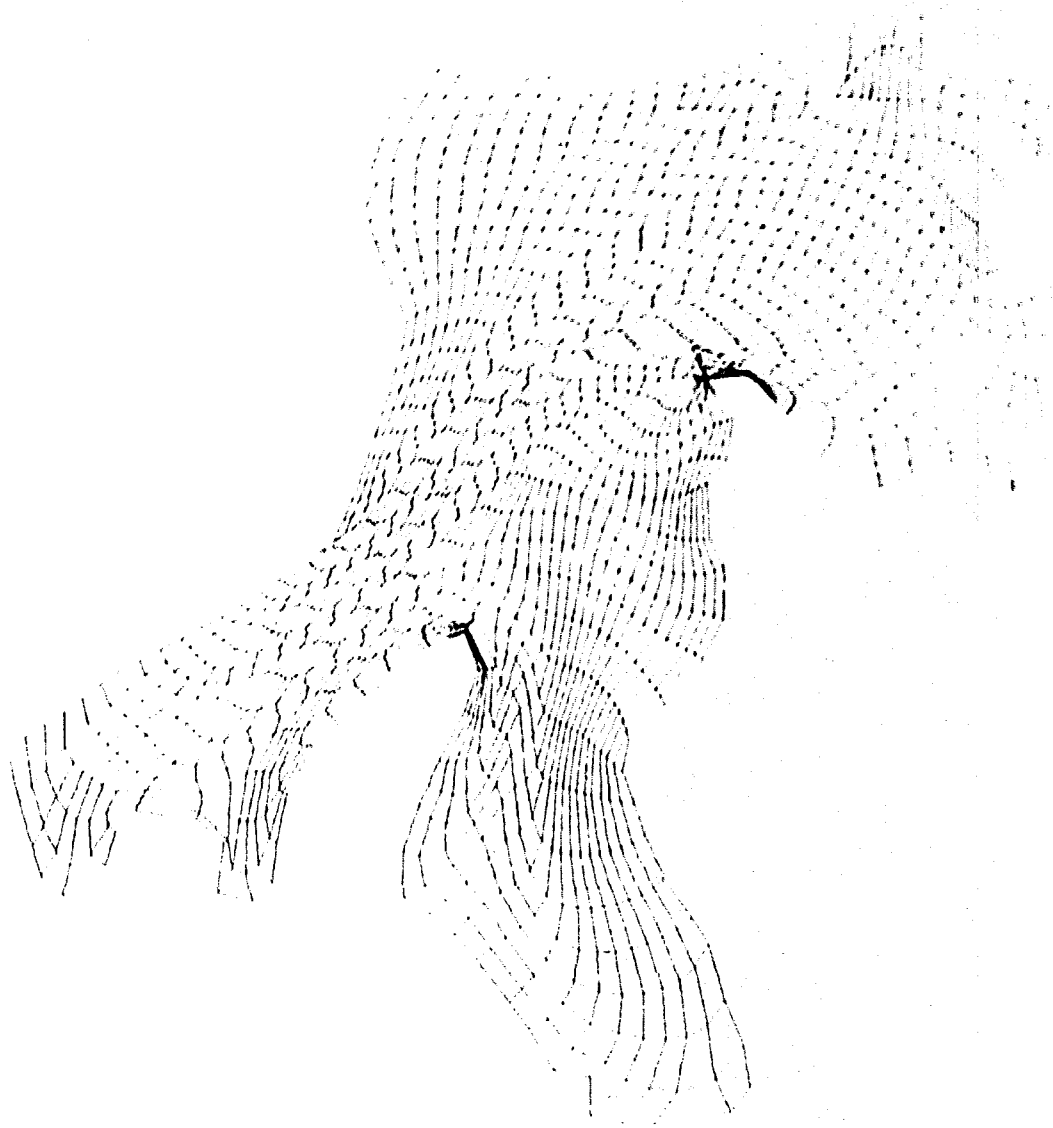
Figura B.4: Bahía de la Habana, 40 puntos por lado. Funcional de área-ortogonalidad (Capítulo 1).
