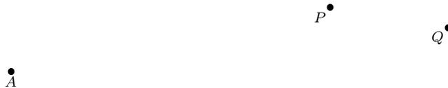
Lo primero que se hace es copiar con el compás la distancia entre los puntos  $P$  y  $Q$ . Para eso se coloca una punta sobre un punto y se abre el compás hasta que la otra punta quede sobre el otro punto.
