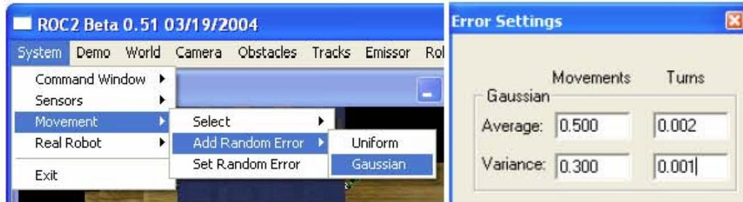
Figura 5.29: Adición de error gaussiano a los movimientos del robot virtual.
