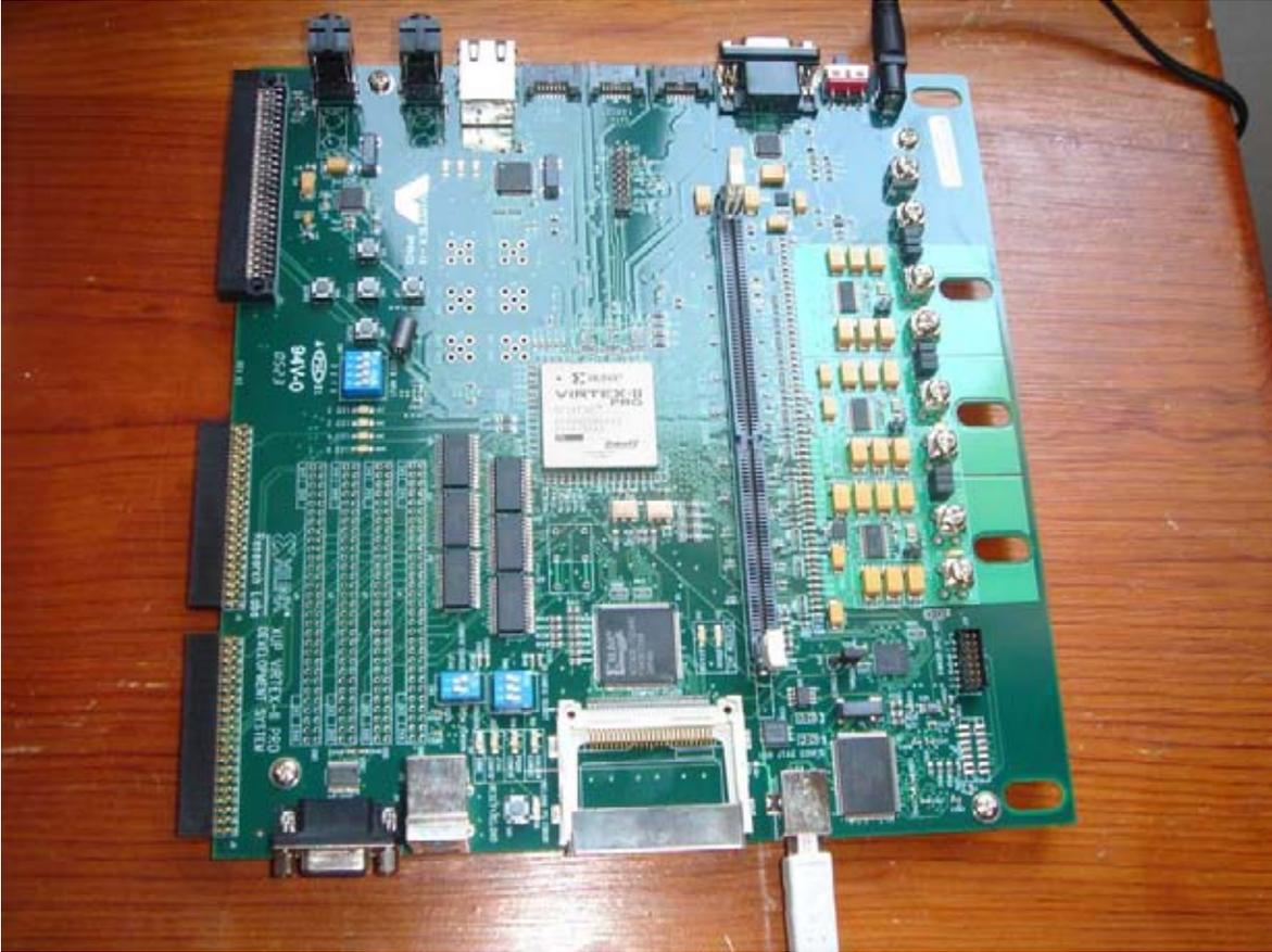
FIGURA 5-3. TARJETA VIRTEX-II PRO, DONDE SE REALIZÓ EL DESARROLLO DEL ASR
