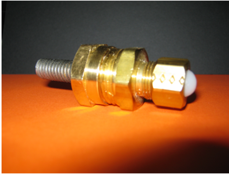
Figura 5.14: Prensa para sujetar las esferas de plástico.
