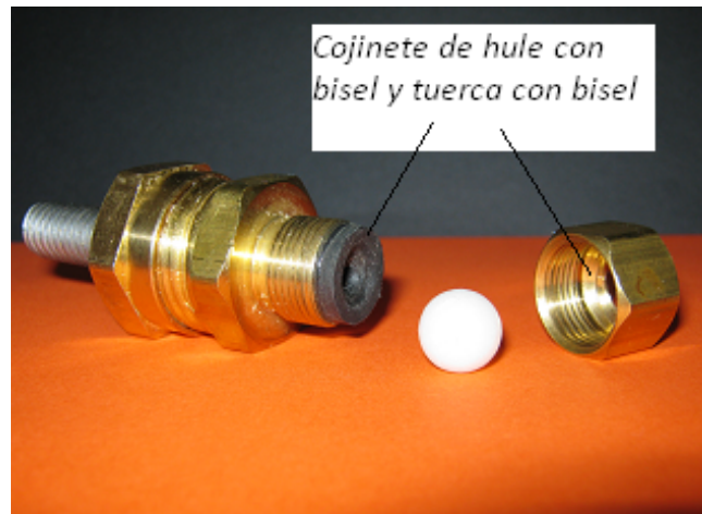
Figura 5.13: Arreglo para sujetar las esferas de plástico con seguridad y sin dañarlas
