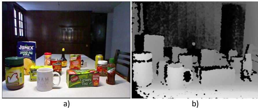
Figura 1. a) Imagen común RGB, b) imagen en profundidad capturada a una velocidad de 30 cuadros por segundo con una resolución de 640x480. En la imagen se observa una escala de grises, la cual representa el nivel de profundidad del pixel.
