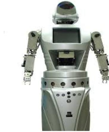
Figura 2.10: Robot *Security Warrior* contaba con dispositivos de sensores incluida una cámara de colores, láser, ultrasónicos y *wireless* [LCLT07].
