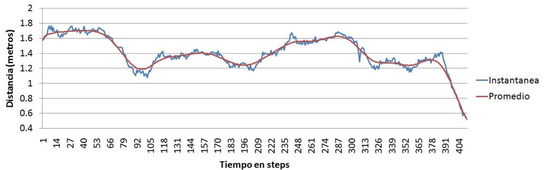
Figura 5.12: Gráfica de distancias obtenidas con láser en el experimento 2.
