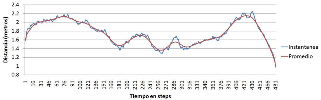
Figura 5.5: Gráfica de distancias obtenidas con *Kinect™* en el experimento 1.
