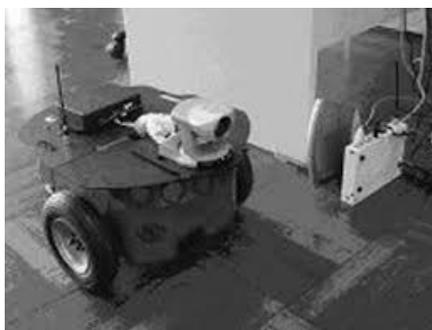
Figura 2.8: Robot *iBotGuard* constituido por dos partes, un robot móvil y un servidor, el sistema en el servidor podía reconocer personas y seguirlas mientras estuvieran frente a él [LWF05].
