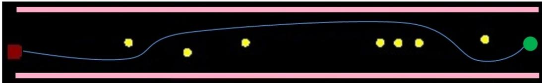
Figura 5.10: Esquema de la distribución territorial del experimento 2, las áreas de color rosa representan obstáculos u objetos del ambiente, los círculos amarillos representan personas, la línea azul indica el trayecto a seguir, el círculo verde representa el final del circuito y el rectángulo un poco deforme de color rojo la posición inicial de la robot.
