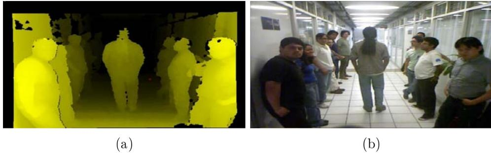
Figura 2.17: Pantallas de la graficación de la información obtenida por el *Kinect<sup>TM</sup>*, en (a) se muestra la información de profundidad respecto al *Kinect<sup>TM</sup>*, mientras más cercas más amarillos y mientras más lejos más negros son los píxeles, y en (b) la imagen RGB.
