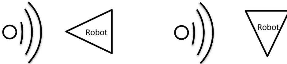
Figura 5.5 En el caso de la izquierda la eficiencia del reconocimiento es 90% pues el robot mira directamente al usuario mientras que en la derecha la eficiencia oscila entre 50% a 70% dependiendo que tan alto hable el usuario.
