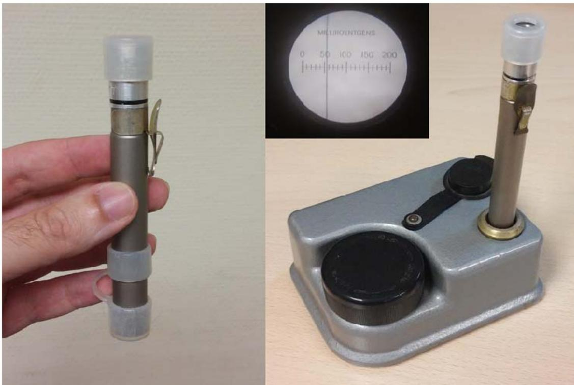
Fig. III.6.- Dosímetro de lectura directa y su respectivo Calibrador.
