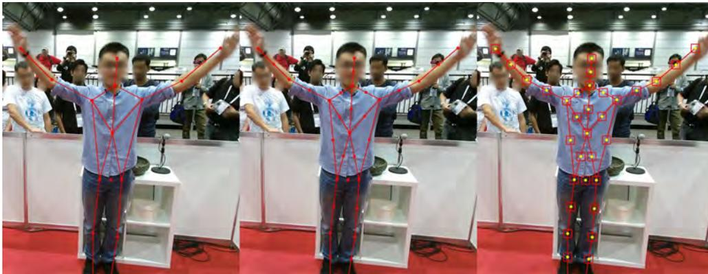
Figura 6.11: Fases de localización de parches en la competencia *RoboCup@Home* 2016. A la izquierda se muestra el esqueleto de la persona. En el centro se indica la localización de los puntos de interés para extraer parches. A la derecha se presentan los recuadros que delimitan los parches de color.
