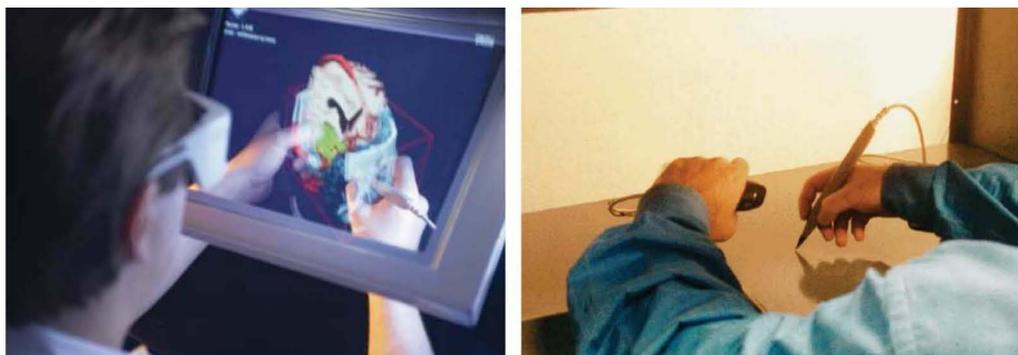
Figura 3.5: Dextroscope. Campo de visión quirúrgico (a la izquierda) y controles posicionales (derecha) que permiten al usuario la interacción con el modelo 3D de paciente específico [25].
