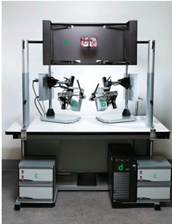
Figura 3.7: Componentes del NeuroTouch [4]. Estereoscópio (a), sistemas hápticos (b), fuentes de poder y amplificadores para los dispositivos hápticos (c), computadora (d).
