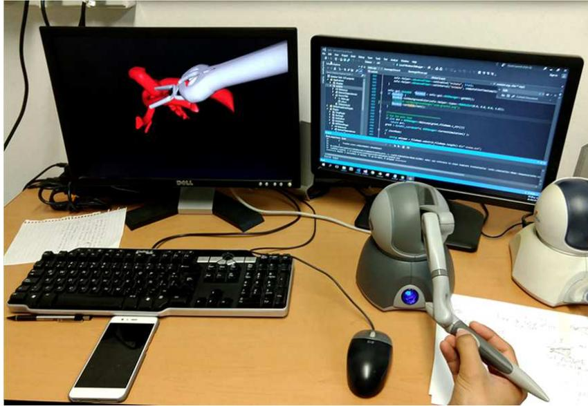
Figura 4.13: Configuración experimental para clipaje de aneurisma cerebral e interacción háptica [39] en SOFA [43].
