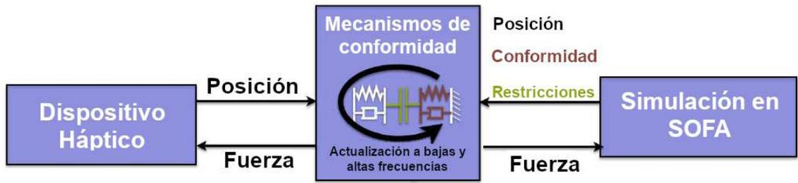
Figura 4.14: La simulación comparte la conformidad mecánica de objetos y las restricciones entre ellos. La respuesta de restricción es calculada a una baja frecuencia dentro del hilo de simulación mientras que el hilo háptico se calcula a altas frecuencias. Un resorte amortiguado de 6 grados de libertad es empleado para acoplar la posición del dispositivo a su posición en la simulación en SOFA [43].
