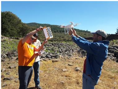
(a) observación del patrón de calibración
