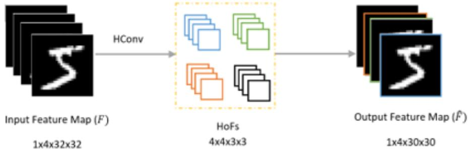
Figura 4.2: Proceso de convolución con filtros modulados HoFs y un mapa de características. Imagen inspirada y modificada de Chen et al [35].
