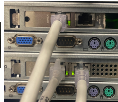
Figura 15. Vista trasera de los equipos firewall y cliente conectados en las tarjetas de red 10Gb Ethernet.
