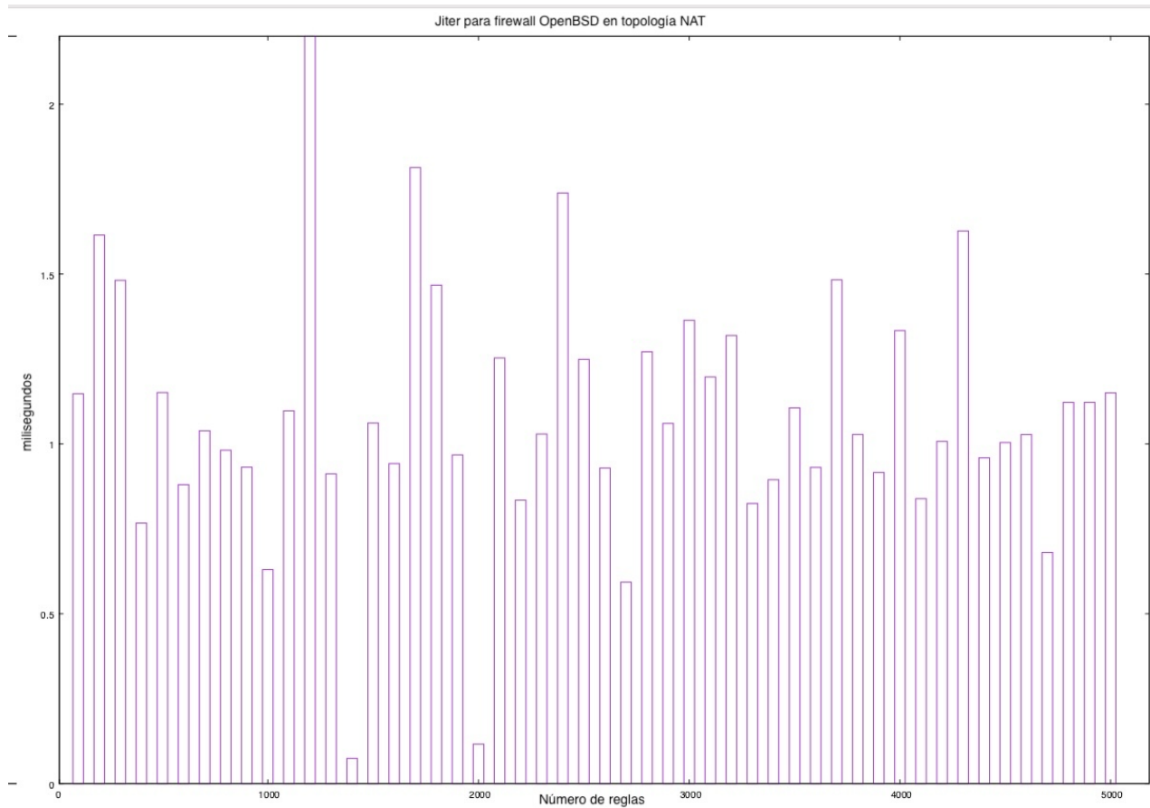
Figura 23. Jitter de 0 a 5000 reglas para firewall OpenBSD utilizando Packet Filter con topología NAT.
