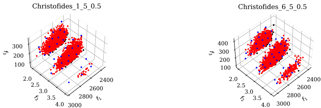
Figura 2.6: Diferentes soluciones en espacio de los objetivos. (azul) Soluciones aproximadas. (negro) Soluciones no dominadas. (rojo) Soluciones encontradas durante la búsqueda.
